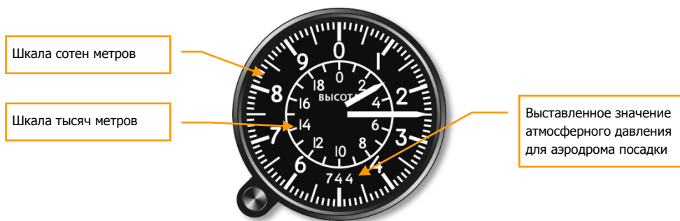
Рисунок 26: Барометрический высотомер
