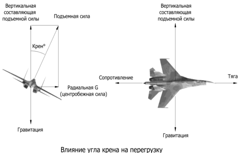
Figure 80: Силы действующие на самолет при маневре
