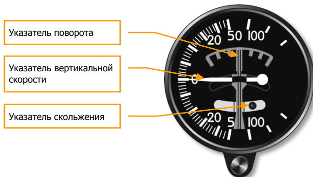
Рисунок 32: Указатель вертикальной скорости, поворота и скольжения
